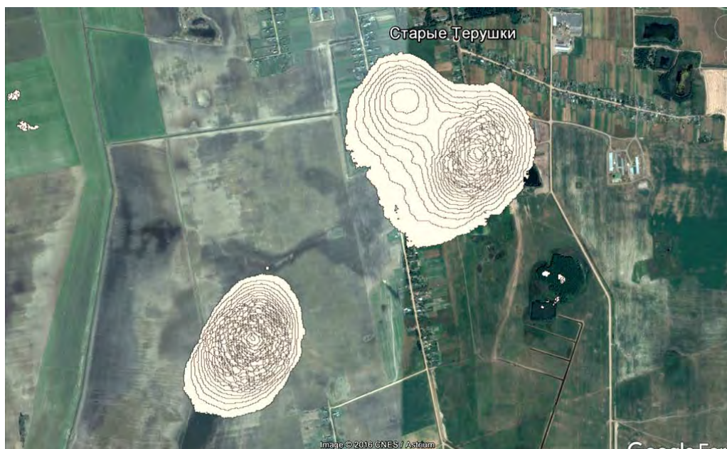
Рисунок 2. – Вертикальные смещения дневной поверхности после всех процедур обработки SAR-сцен
