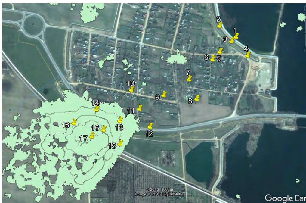
Рисунок 6. – Мульда оседаний по лаве 102, построенная по SAR-данным (на период 28.08-19.09)
