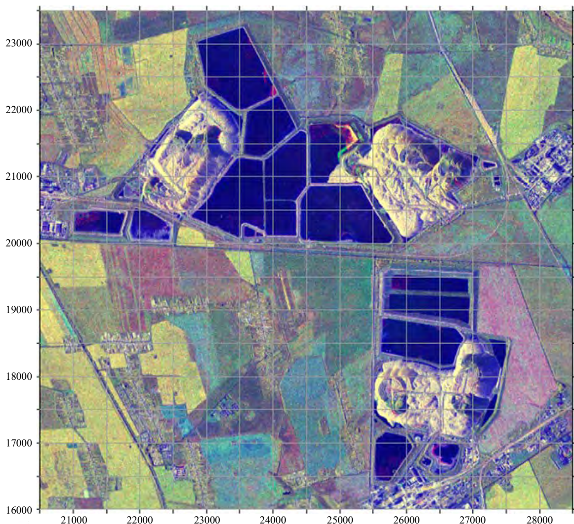
Рисунок 12. – Цветной композит по паре снимков за даты 12.07.2015 и 23.07.2015 г. (11 дней), полученный на размере пикселя 3 на 3 м (система координат – местная). Район РУ-1 – РУ-3
