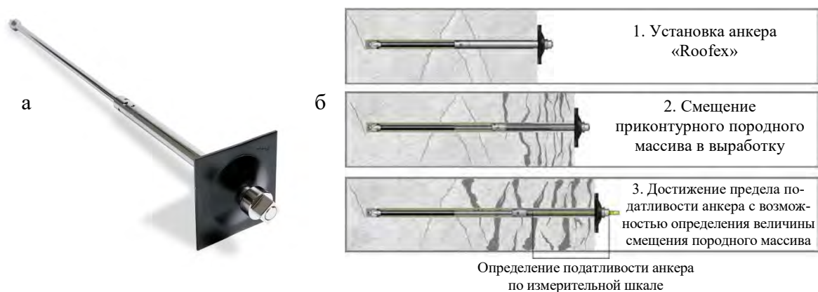
Рисунок 6. – Внешний вид анкера «Roofex» (а) и схема работы анкерной системы (б)
