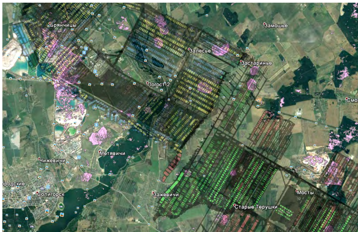
Рисунок 3. – Совмещенные планы горных работ и поля оседаний земной поверхности
