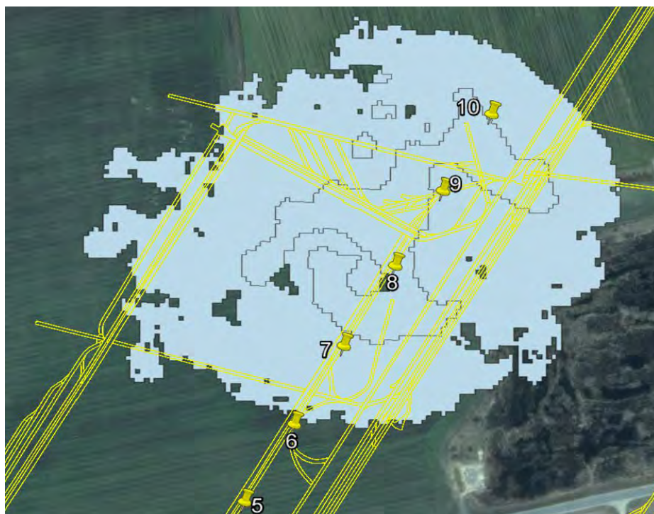
Рисунок 8. – Мульда оседаний по лаве 19-2, построенная по SAR-данным (на период 08.09-19.09)
