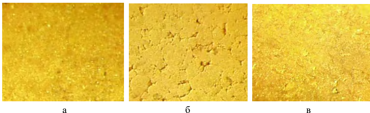
а – пластичное прессование; б – сухое прессование; в – литье под давлением Рисунок 2. – Структура поверхности отформованного материала ВК94-1, полученного различными методами
