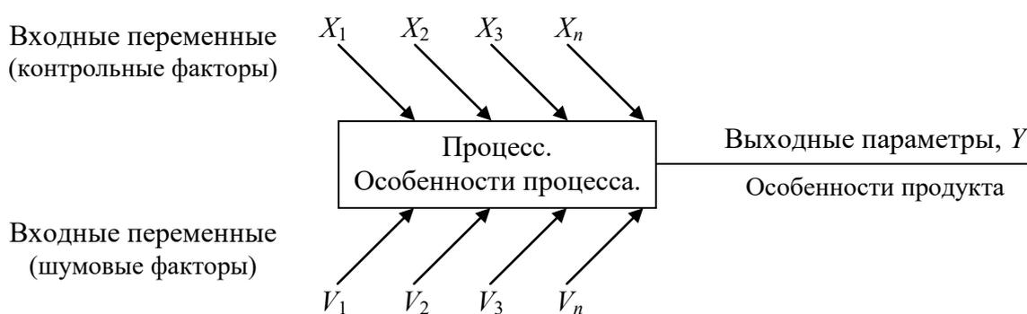
Рисунок 1. – Процесс входных и выходных параметров
