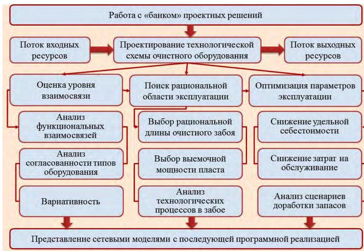
Рисунок 1. – Схема проектирования технологических схем очистного оборудования
