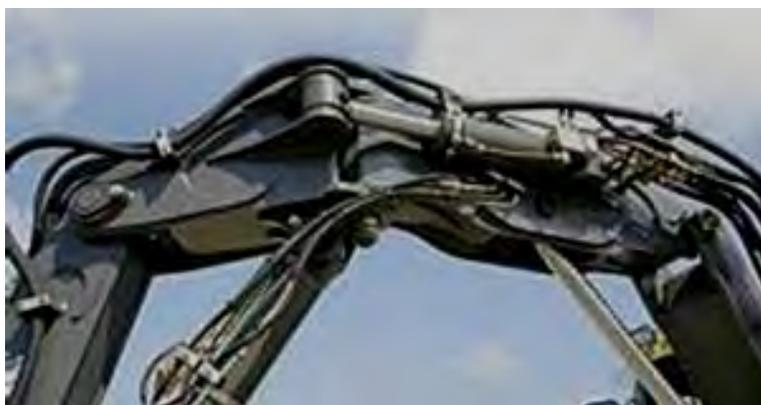
Рисунок 1. – Фотография гидроцилиндра с подвижным штоком
