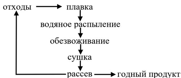
Рисунок 2. – Схема производства ФАП
