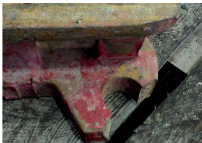
Рисунок 5. – Излом проушины крепления зубчатой рейки
