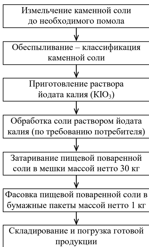
Рисунок 3. – Технологическая схема производства пищевой соли на ОАО «Беларуськалий»
