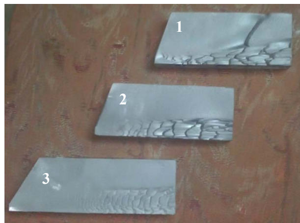
1 – лопатки, установленные назад относительно оси вращения ускорителя; 2 – установленные нормально; 3 – установленные вперед Рисунок 4. – Износ лопаток ускорителя
