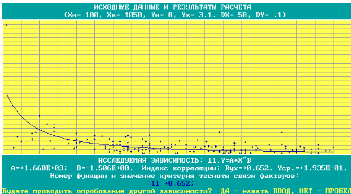
Рисунок. – Результаты моделирования сейсмического эффекта взрывов в карьере «Микашевичи» (зависимость амплитуды смещения грунта от расстояния)
