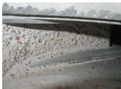
Рисунок 2. – Лопатка после самофутеровки измельчаемым материалом
