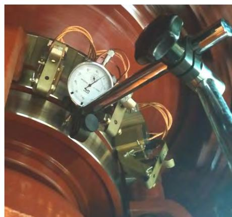
**Рисунок 4. – Измерение биения контактных колец**
