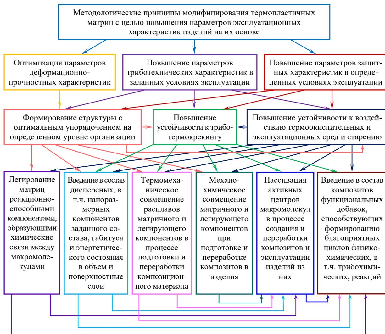
**Рисунок 2. – Методологические принципы модифицирования термопластичных матриц с целью повышения параметров эксплуатационных характеристик изделий из них**
