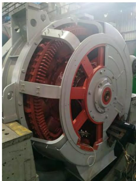
**Рисунок 1. – Генератор тяговый синхронный ГС501А**
