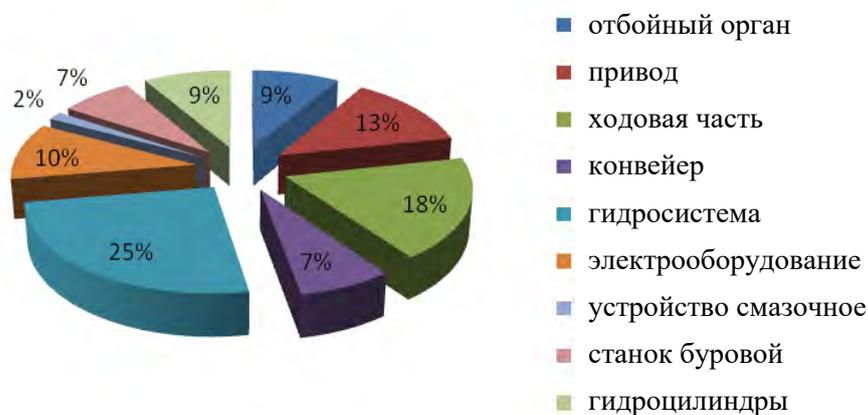
Рисунок 3 – Классификация отказов проходческих комбайнов
