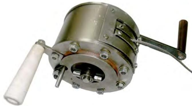
**Рисунок 4 – Экспериментальный образец РПТМ со сферическими подшипниками**
