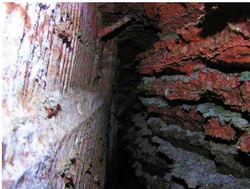
**Рисунок 1 – Растворение сильвинитовых пород (справа) в боковой стенке разведочной выработки № 12 по контакту с временной гидроизоляционной перемычкой (слева)**
