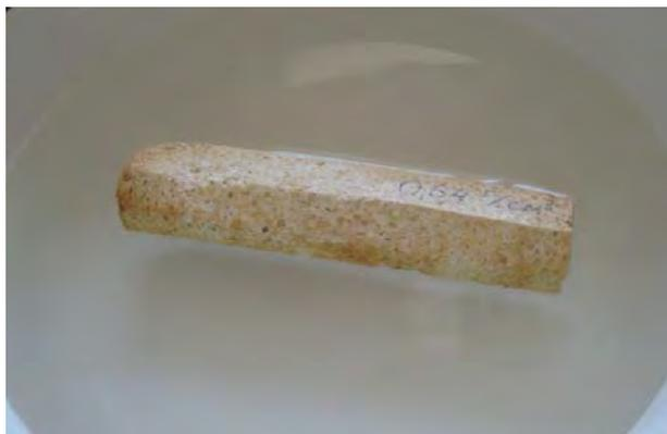
**Рисунок 5 – Испытание гипсополимерного образца на стойкость к воде**
