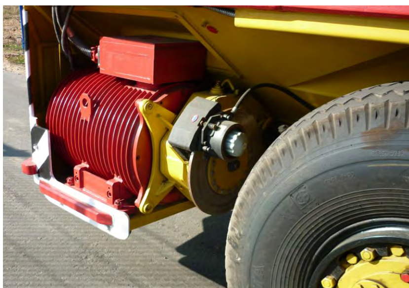
Рисунок 1 – Привод колес шахтного самоходного вагона ВС-17
