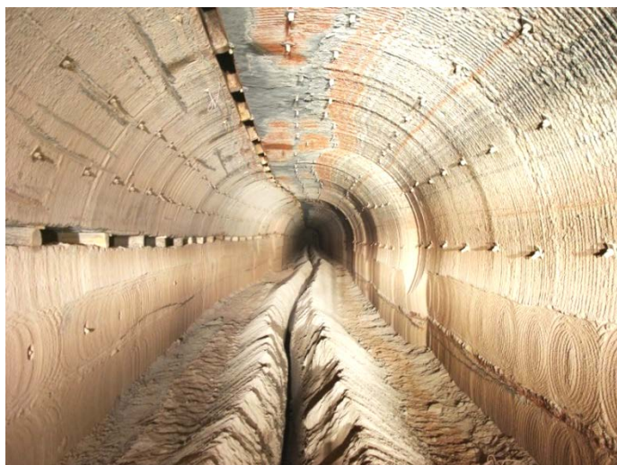
Рисунок 2. – Щели, нарезанные машиной врубовой баровой
