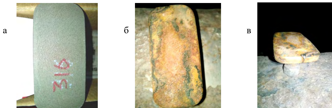
а – до испытаний; б, в – после двух месяцев испытаний
