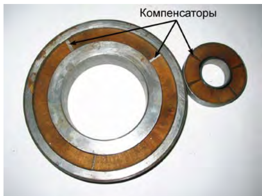
Рисунок 1. – Подшипники с составным вкладышем, разделенным компенсаторами
