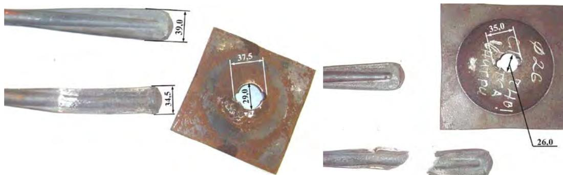
Рисунок 9 – Вид узлов податливости после испытаний
