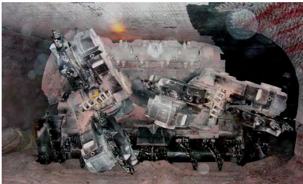
**Рисунок 1 – Вид спереди (со стороны забоя) на спаренный исполнительный орган проходческо-очистного комбайна**
