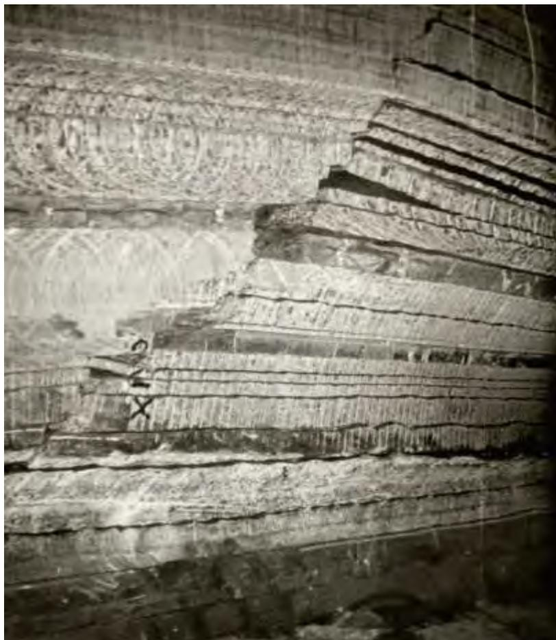
Зона разрыва слоев, характеризующаяся как водопроводящий канал, в подработанном массиве располагается в зоне разгрузки напряжений у границы очистной выработки под углом  $64^\circ$  к горизонту от забоя лавы в сторону выработанного пространства.
