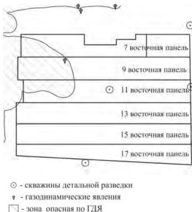
**Рисунок 1 – Прогнозная карта зон опасных по ГДЯ для сильвинитового пласта АБ в пределах юго-восточной части шахтного поля рудника БКПРУ-2**
