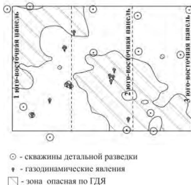
**Рисунок 2 – Прогнозная карта зон опасных по ГДЯ для сильвинитового пласта АБ в пределах шахтного поля рудника БКПРУ-4**
