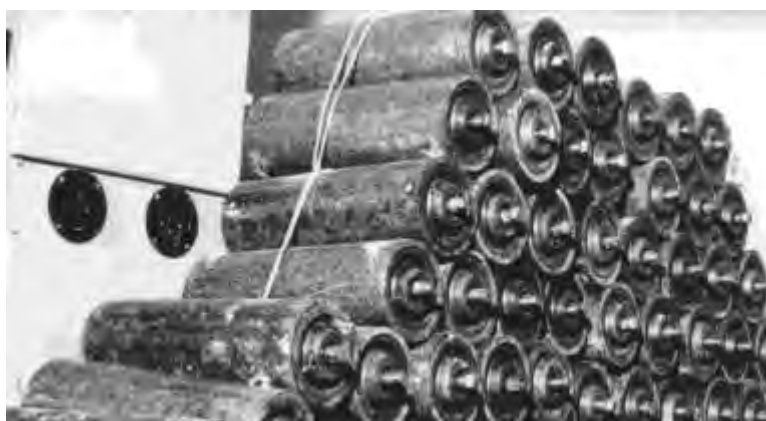
Рисунок 5 – Образцы роликов ленточных конвейеров из ДПКА-1, ДПКА-4
