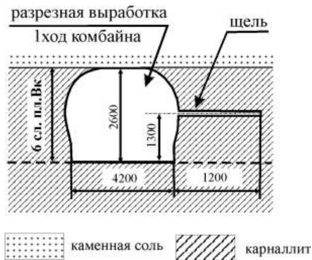
Рисунок 2 – Общий вид исследовательской выработки с горизонтальной щелью в стенке
