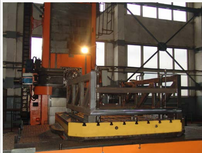
Обработка редуктора на станке WHN 15 CNC
