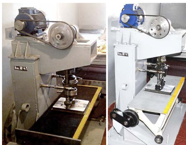
Стенд динамического испытания ступеней и пластин
