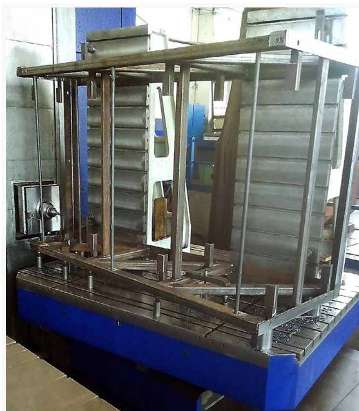
Обработка металлоконструкции на станке WRD 150
