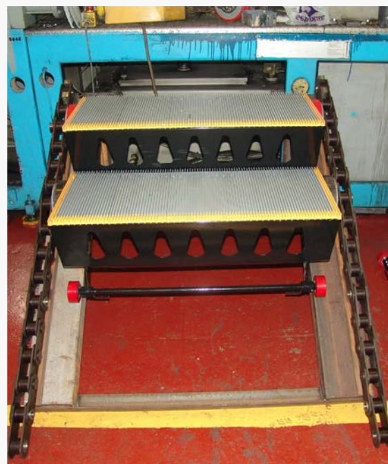
Стенд для контроля сборки лестничного полотна
