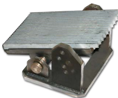
Стенд испытания настила на скольжение
