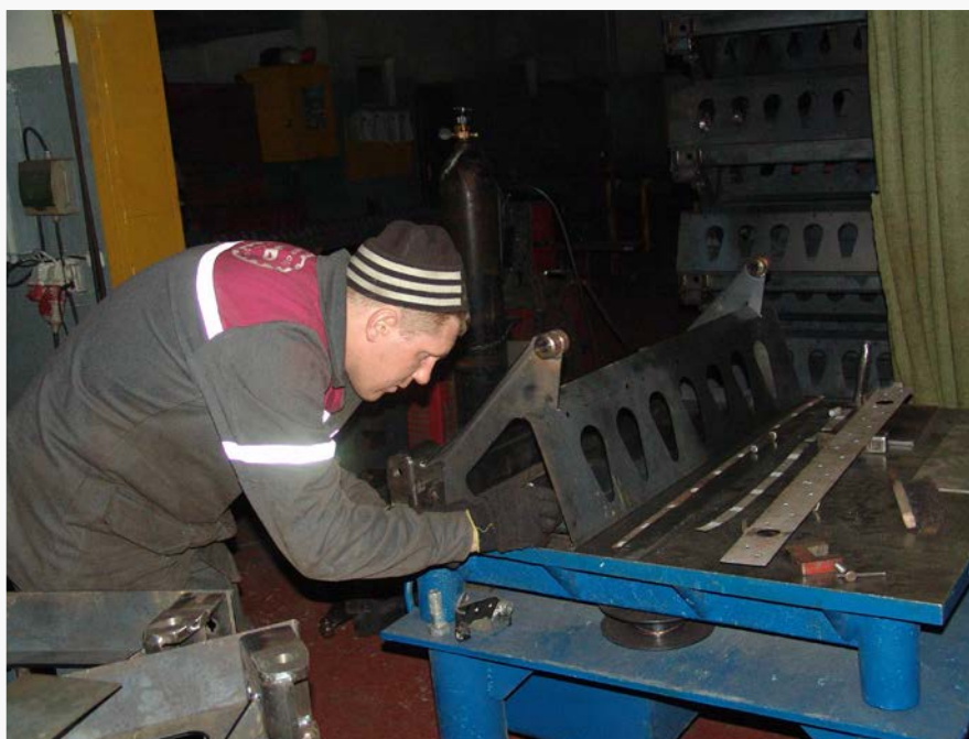
Сборка каркаса ступени
