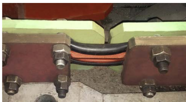
Стенд испытания поручня на статическую нагрузку
