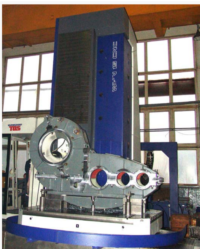
Обработка редуктора на станке WHN 15 CNC
