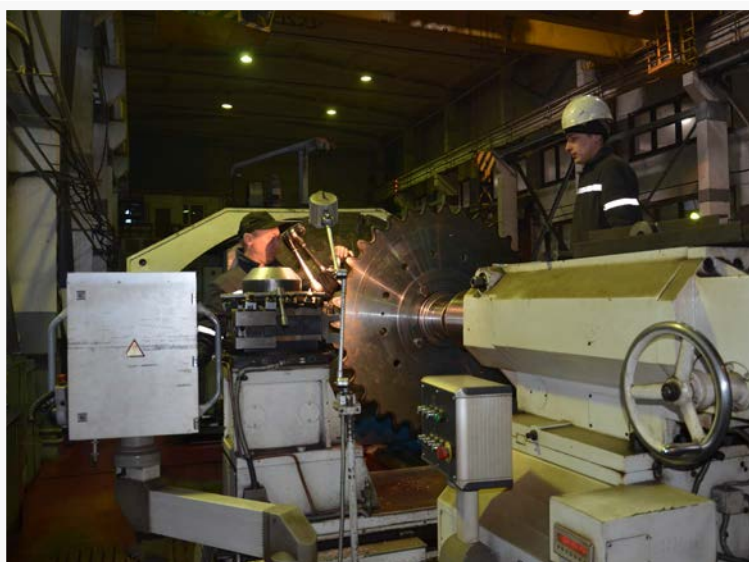
Обработка металлоконструкции на станке WRD 150
