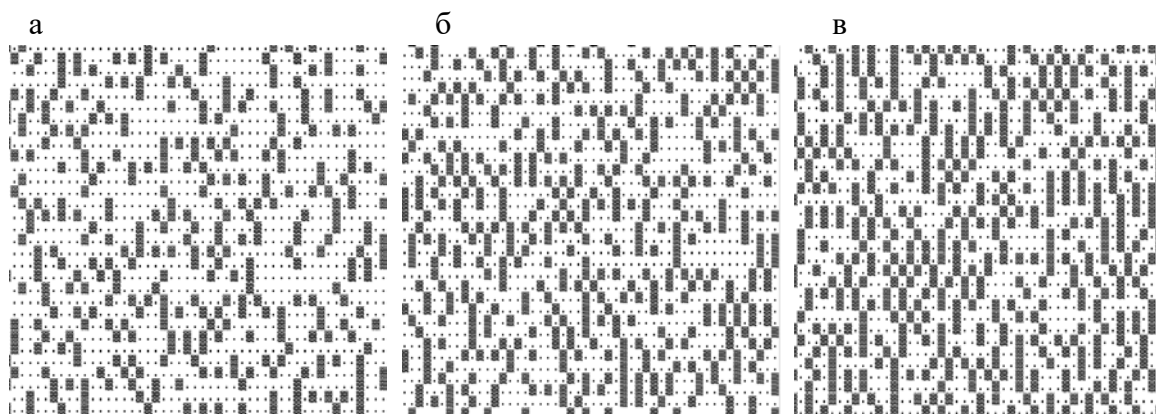
Рисунок 3. – Система пор в композиционном материале с содержанием пластификатора от 15 мас. % до 50 мас. %
