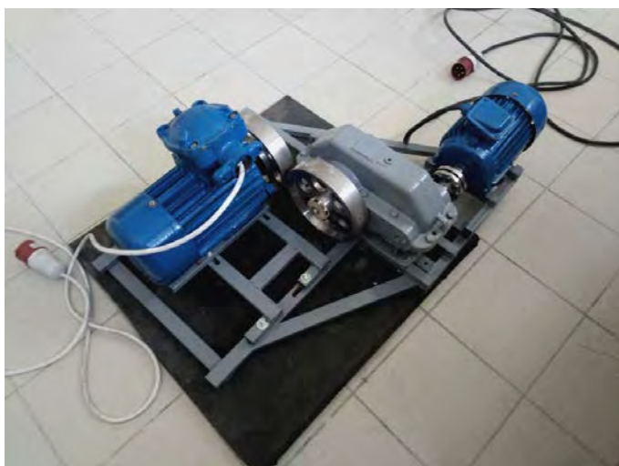
Рисунок 1. – Лабораторная установка вибровалкового измельчителя
