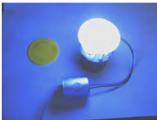
**Рисунок 10. – Макет светодиодного светильника с круглым полимерно-кристаллическим светопреобразователем**
