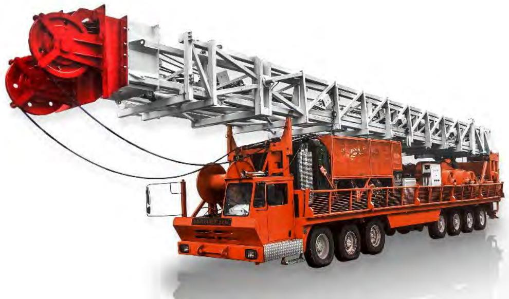
**Рисунок 5. – Мобильная буровая установка МБУ «Медведь»**
