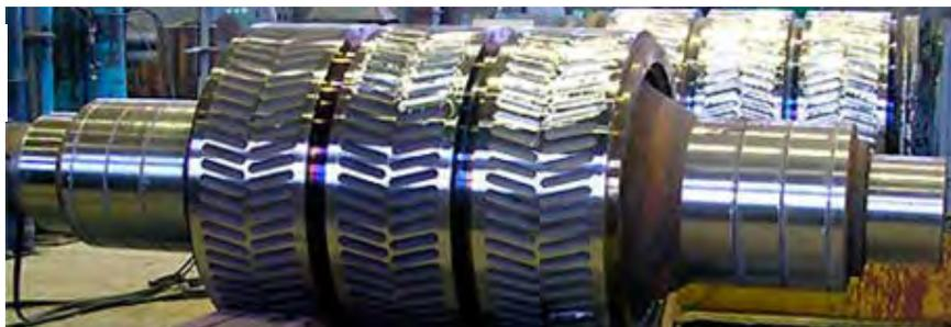
**Рисунок 1. – Общий вид вальц-пресса (а) и валка с формующими элементами на рабочих поверхностях (б)**
