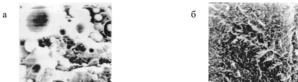
**Рисунок 4. – Характерная морфология композита сравнения ПА 6 – СФД (а) и композита ПА 6.6 + ПА 6 (б). Сколы в азоте. Содержание компонентов 50:50 мас. %**
