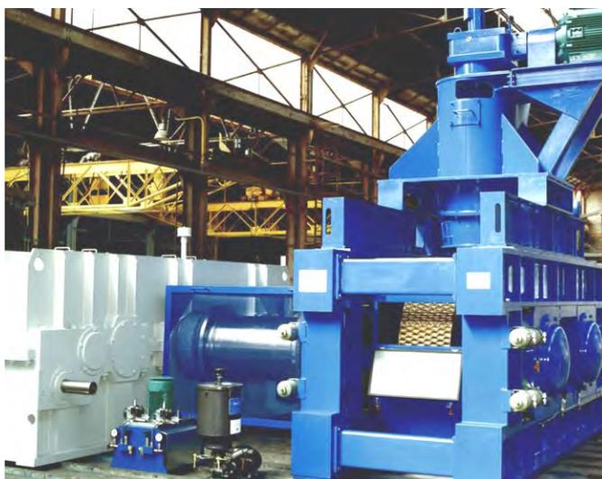
**Рисунок 5. – Брикетирующий пресс фирмы FEEECO INTERNATIONAL INC.**
