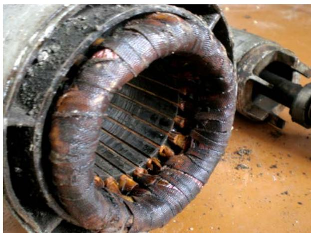
**Рисунок 3. – Обмотка электродвигателя после длительного воздействия высоких температур**
