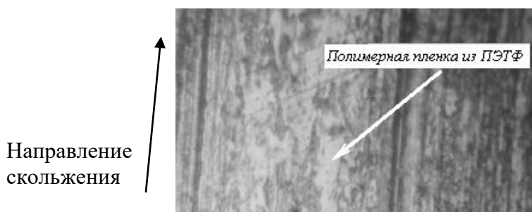
Рисунок 1 – Микрофотография поверхности металлического вала с образовавшейся на нем полимерной пленкой из полиэтилентерефталата
