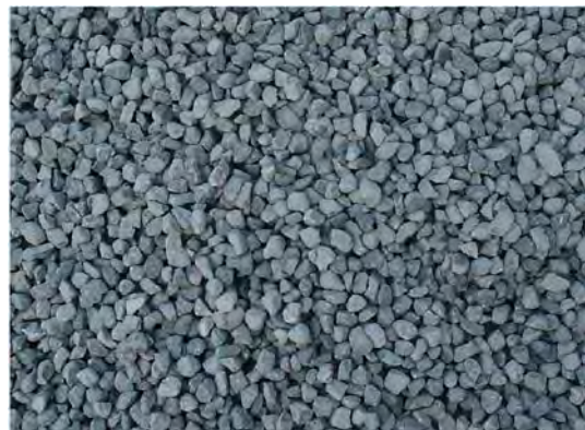
Рисунок 1 – Кубовидный щебень, полученный на дробилке ДЦ-1,6
