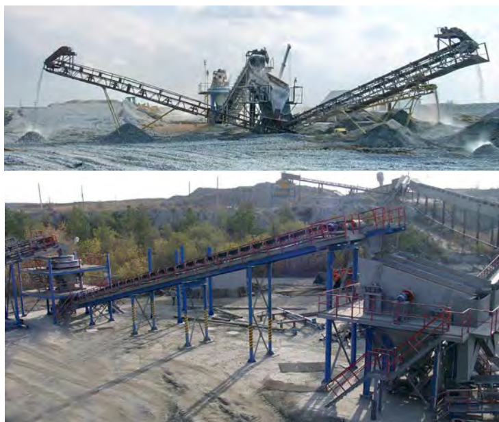
Рисунок 5 – Центробежно-ударная дробилка марки ДЦ в работе
