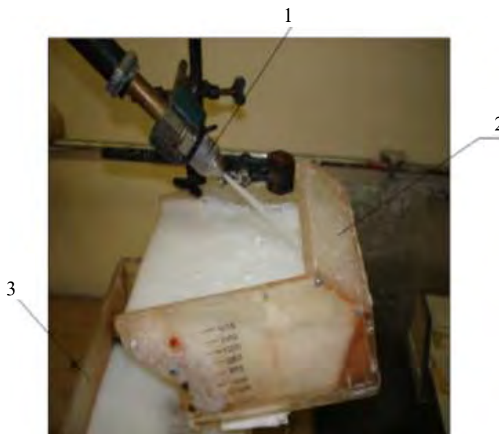
1 – форсунка; 2 – пенообразующая емкость; 3 – масштабная модель флотационной камеры
