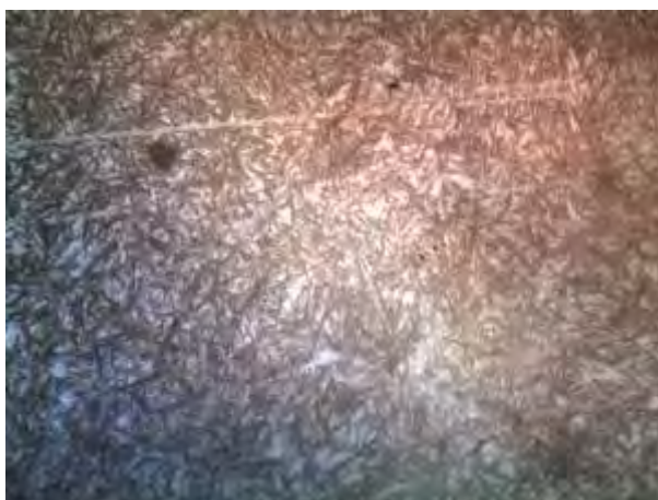
Рисунок 4 – Структура цементационного слоя с остаточным аустенитом без высокого отпуска
