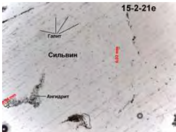
Рисунок 1 – Кристаллы ангидрита на контакте сильвина и галита, приуроченные к каемкам гидроокислов железа
